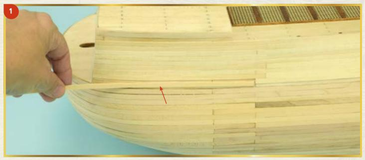
1 На данном этапе мы снова займемся монтажом чистовой обшивки корпуса, а затем перейдем к работе над второй шлюпкой модели. Возьмите планку 0,5 x 5 x 300 мм и приклейте ее к носовой части левого борта корпуса, рядом с последней планкой, которую вы приклеили на предыдущем этапе. Будьте внимательны: передний конец планки должен быть обрезан вровень с переборкой.
