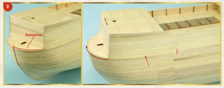
**3** Теперь вы можете начать новый ряд, приклеив планку к носовой части модели. Передний конец этой планки обрежьте таким образом, чтобы в обшивке модели остался паз для установки форштевня. Ее верхний край надо обрезать вровень с палубой.
